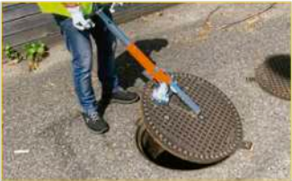
Utilisation 3 : ouverture avec levier avant déployé
