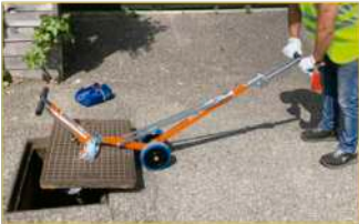
Utilisation 2 : soulèvement avec levier rabattable
